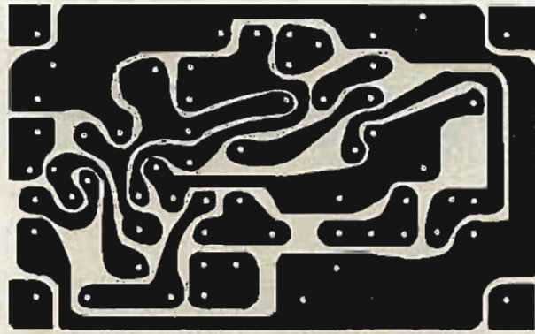
Fig. 4/a - Basetta a circuito stampato vista dal lato rame in grandezza naturale.
