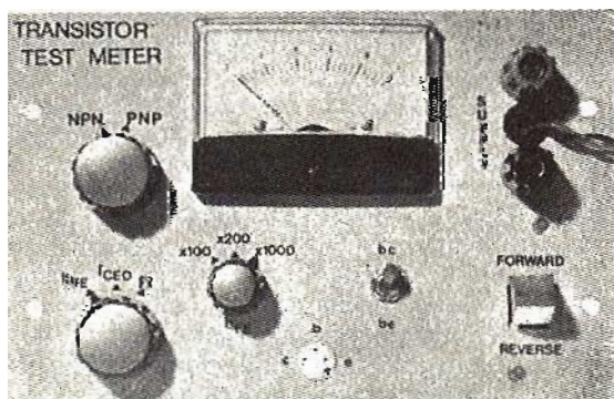
Fig. 5 - Disposizione dello strumento, dello zoccolo di raccordo e dei vari commutatori e morsetti, sul pannello frontale.
